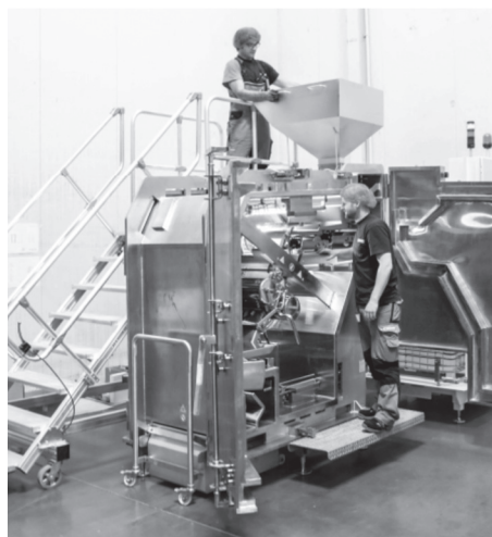
図6 乾燥食品用の低エネルギー電子線照射装置(ドイツ)
