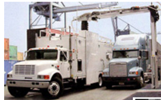
米国でのトラック の検査風景
