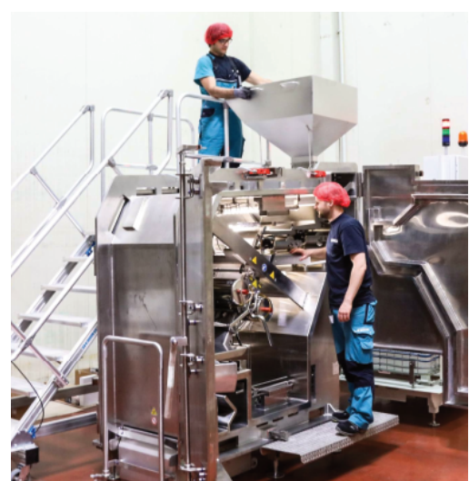
乾燥食品原料用低エネルギーEB装置(ドイツ) (写真提供 Buhler 社)
