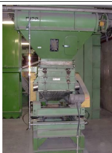
主原料フル装置 粉碎されたトウモロコシなどの 適正サイズをふるい分ける
