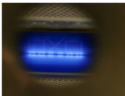
コバルト 2 棟第 7 照射室 7 セル の線源 (約 14 万キュリー)
