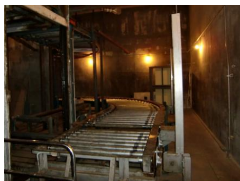
製品に照射処理を行うためコンベアで移動
